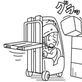
・積載した荷が崩壊したが、**歩車分離エリア**として人の立ち入りを制限していたため、荷と作業者が接触せずに済んだ。
